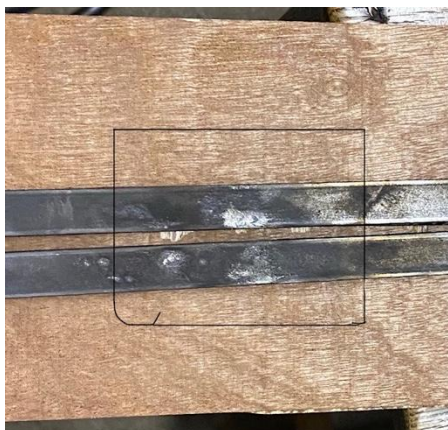
Afbeelding 48: op de foto is te zien dat het ontladingsgedeelte op de rails beperkt is.
