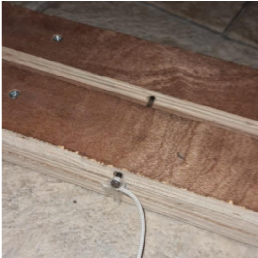
Afbeelding 22 en 23: Op de linker afbeelding is te zien hoe de pin wordt geplaatst bij het opspannen van de boog en op de rechter afbeelding is de pin zelf te zien.
